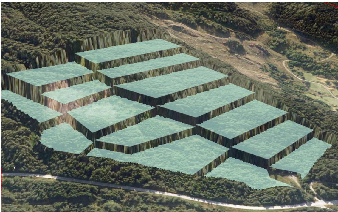
**Figur 6-1 Prinsipp for utforming av steinbrot. Brytningsplana er vist med grøn farge. Kjelde: 3D-modell Multiconsult.**
