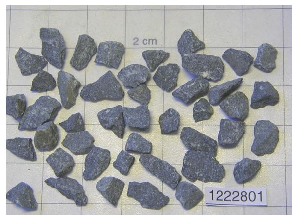
**Figur 5-13 Handstykke, fastfjellsprøve.**
