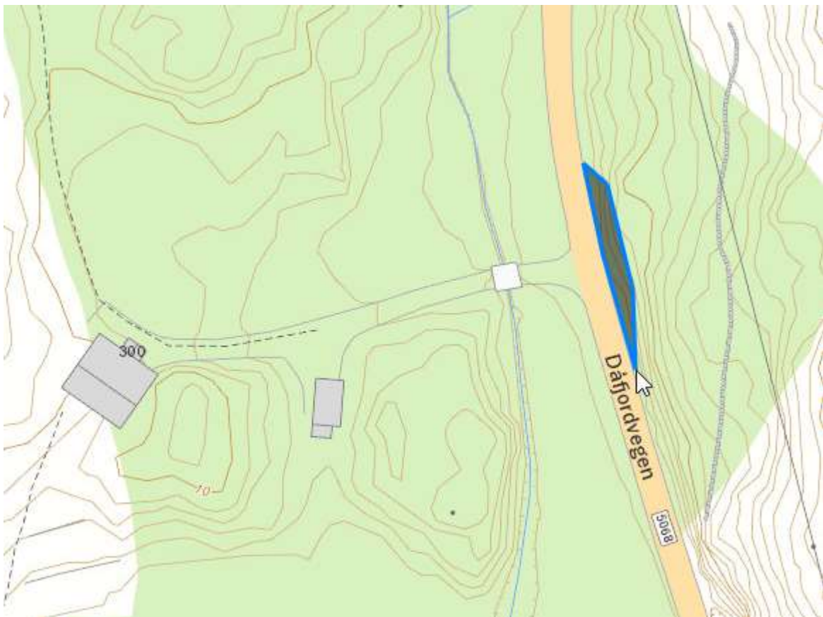
Tiltak pos.4: Sprenging for sikt. Fartsgrense 60 km/t. Areal ca. 40 m 2 . 4 høgdekoter (snitt 2,5?)
