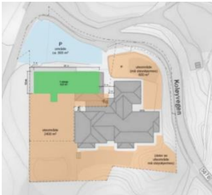
Figur 9 Alternativ 4a, med barnehage i modulbygg (grønt rektangel på skissa), det vert plassera delvis over fotavtrykk til gamleskulen, og sør for parkeringsområde, i aust/vest retning.
