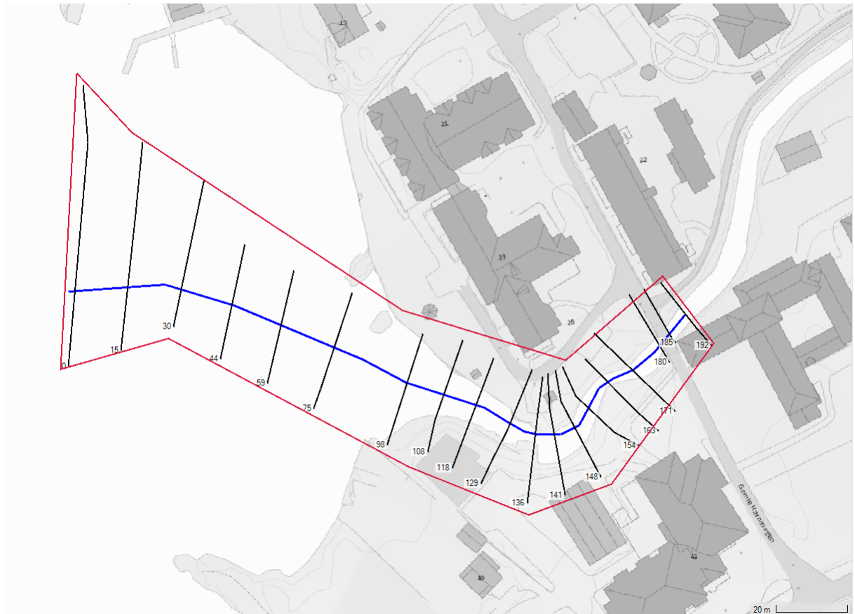
Figur 5-1: Kart som viser plassering av tverrprofil og avgrensning av analyseområdet for den hydrauliske modellen.
