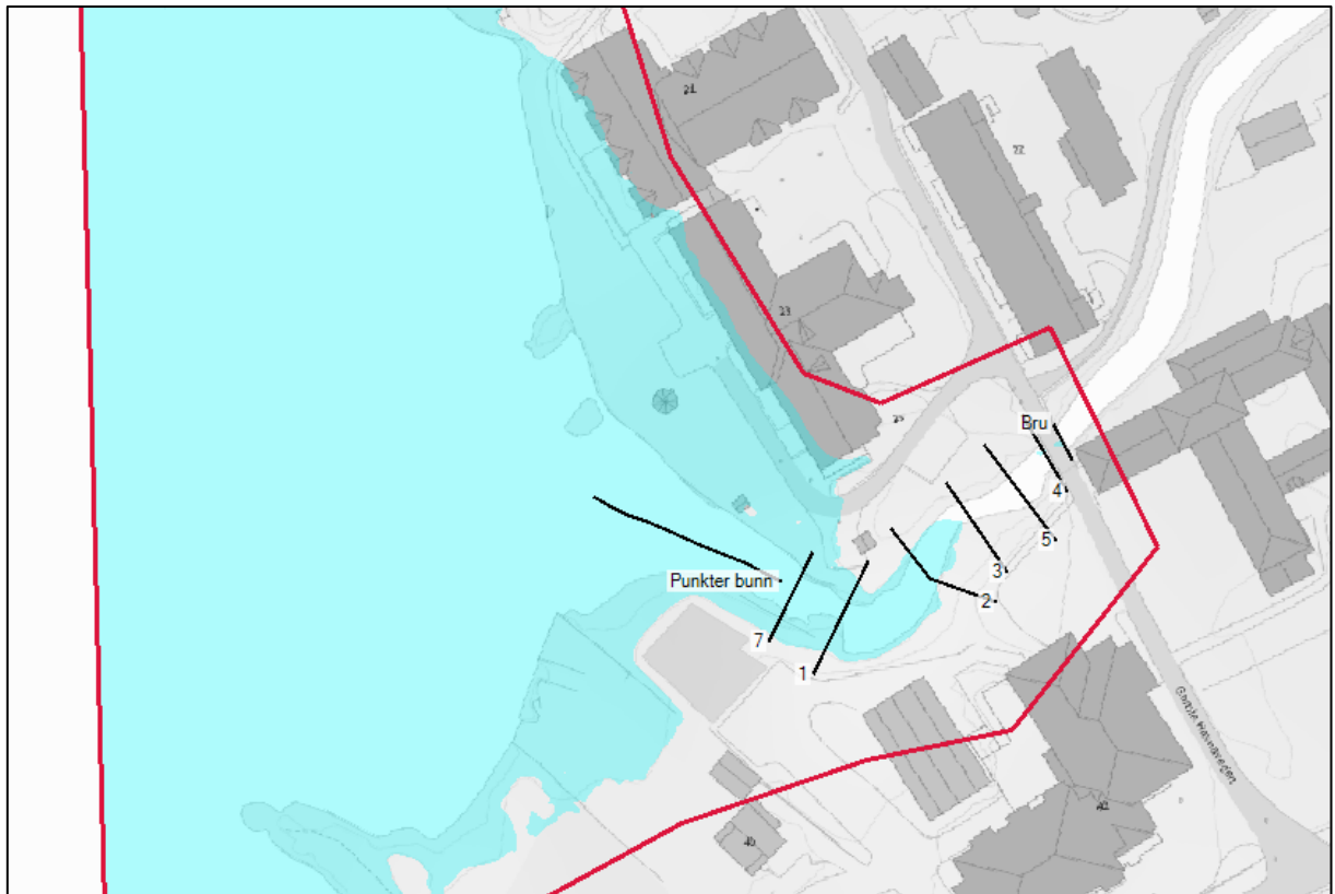
Figur 5-2: Kart som viser 1000års stormflo for Fitjar i år 2100. Rød linje markerer området som det er analysert med tanke på stormflo. Sorte linjer er plassering av oppmålte tverrprofil fra Fitjar kommune.
